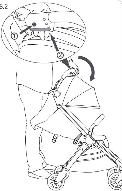
8.2 タイヤをロックし、ハンドルの2つのボタン①②を同時に押すように握り、フレームが完全にロックされるまでハンドルを前方に押し下げます。
