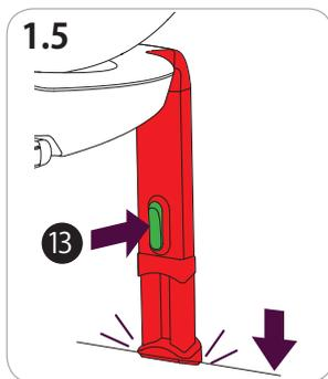
1.5 ボタン⑬を押し、サポートレッグ⑫が床にしっかりとつく位置に高さを調整します。この時点で、サポートレッグがチャイルドシートに対して90度になっているのが正しい位置です。ISOFIXインジケータは、コネクタが開いているか閉じているかを示します。コネクタが閉じていても、ISOFIXポイントにロックされていない可能性があります。取り付けたらシートを引いて、すべてのコネクタが車両のアンカーポイントに正しくロックされていることを確認してください。
