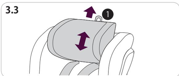
3.3 ヘッドレスト②を調整するには、上部のレバーハンドル①を引きます。正しい位置に設定する必要があります。(次の工程3.4の図を参照)
